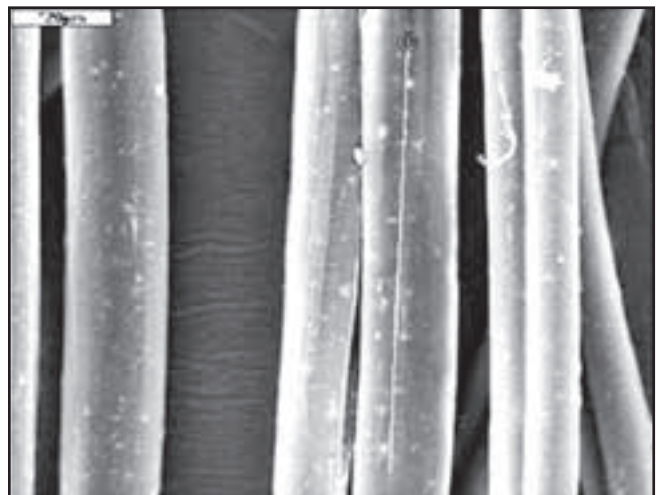
شکل ۹. تصویر طولی الیاف SG ۹. (شکل ۱۰ را هم ببینید.)
