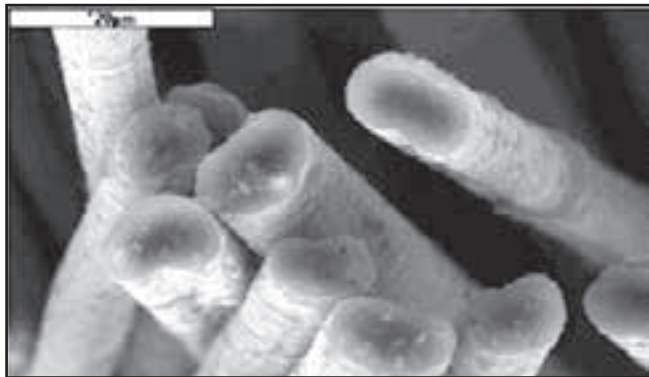
شکل ۱۳. سطح مقطع الیاف کربنیزه شده GH ۹.
